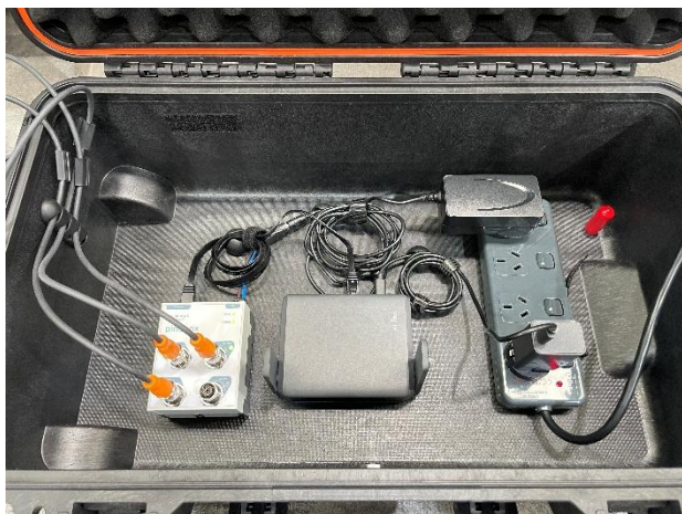
Im Inneren des Testkoffers: Pinebox, WLAN-Zugang und Stromverteilung
